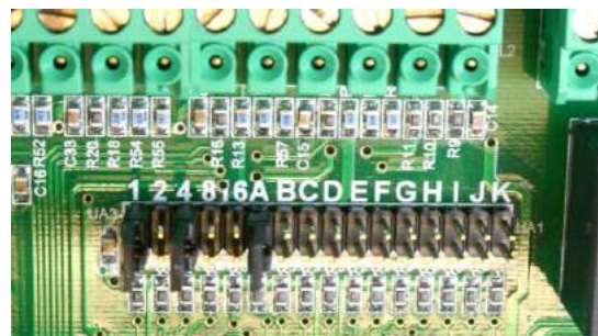
Bild utvisande bygel A, 1 och 4 är på. (Betyder fristående drift och 5 spjäll anslutna.)
